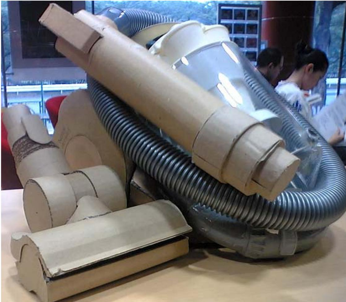
Fig.9 掃除機の試作品 (ダンボール製:ダイソンエンジニアングレクチャにて)
